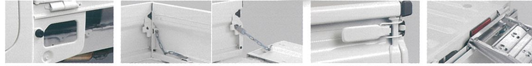
大型荷台昇降用ステップ(左右) 格納式リヤアオリチェーン ワンタッチ式ゲートロック 歩み板対応リヤアオリ ●歩み板は商品には含まれません。
